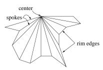
Fig. 4. A fan triangulation.
